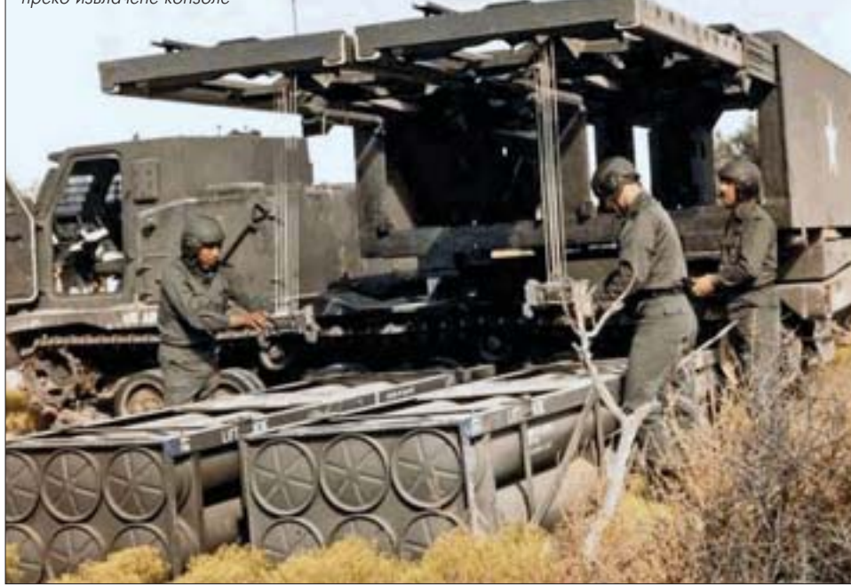
Попуна шестоцевним модулима преко извлачеће конзоле
